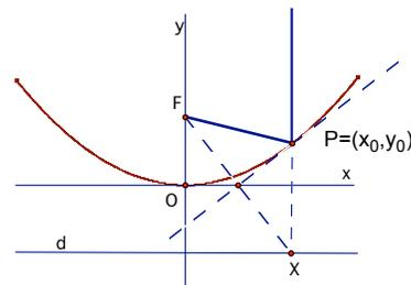
**Refletor parabólico** Os raios de luz de uma lâmpada no foco  $F$  de um espelho parabólico refletem paralelamente ao eixo da curva. Justifique levando em conta que o ângulo entre o raio incidente e a reta tangente é igual ao ângulo entre essa reta e o raio refletido.
