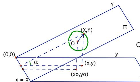
**Seções planas de cilindro circular reto.** A seção de um cilindro circular reto por um plano fazendo um ângulo  $\alpha$ ,  $0 < \alpha < 90^\circ$ , com o plano da base é uma elipse. *Justifique.* E se  $\alpha = 0^\circ$  ou  $90^\circ$ ?
