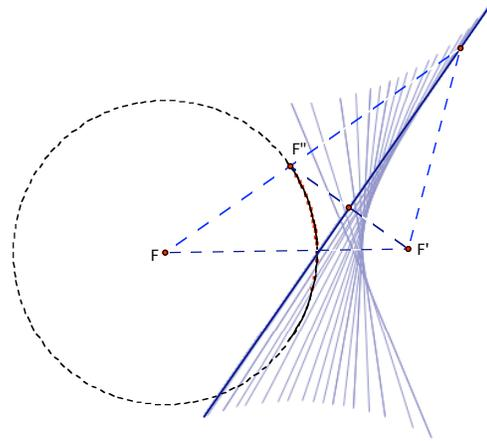
**Telescópios refletores** Como vimos antes os raios vindos de um corpo celeste (praticamente paralelos) refletem em um espelho parabólico no fundo de um tubo formando a imagem do corpo no foco  $F$  da parábola.
