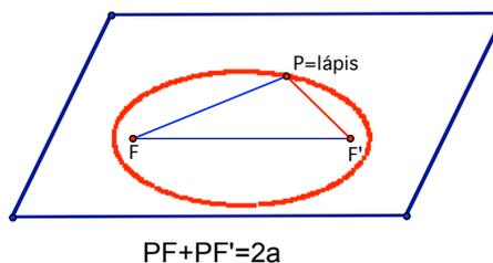
Fixe as extremidades do fio em F e  $F'$  e movimente um lápis mantendo o fio esticado. Ele desenhará os pontos P da elipse de focos F e  $F'$  e excentricidade e. Justifique.
