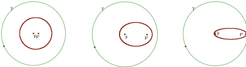
**Mecanismo de fio esticado para traçar elipses** O seguinte aparato permite o traçado contínuo da elipse dados os focos F e  $F'$  com  $FF' = 2c$  e a excentricidade  $e < 1$ . Seja uma placa, com dois pinos F e  $F'$  fixados tais que  $FF' = 2c$ , e um fio flexível de comprimento  $2a$  com  $a = c/e$ .
