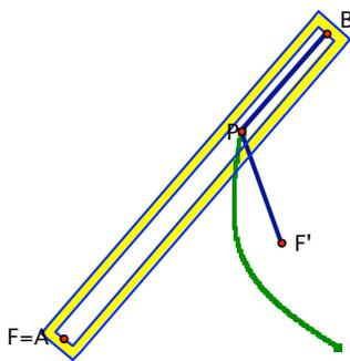
ramo da hipérbole de equação  $|PF - PF'| = AB - \ell = 2a < FF' = 2c$ . Observe, na figura, que  $AB - \ell = PF - PF'$ . Mude o comprimento  $\ell$  do fio e observe como mudam as hipérbolas!
